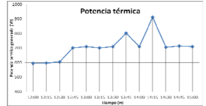
Potencia térmica generada por el Panel Solar Híbrido
