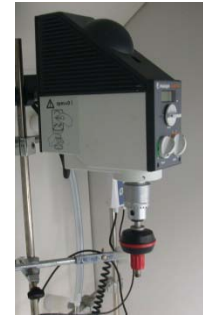
Agitador mecánico (2500 r.p.m.r)
