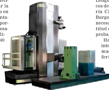
■ Máquina modelo SUPRA, máquina típica para mecanizado del sector eólico debido a su versatilidad y altas prestaciones dinámicas.
